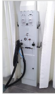
Totem de ponçage multi-énergies avec asservissements sécuritaires
