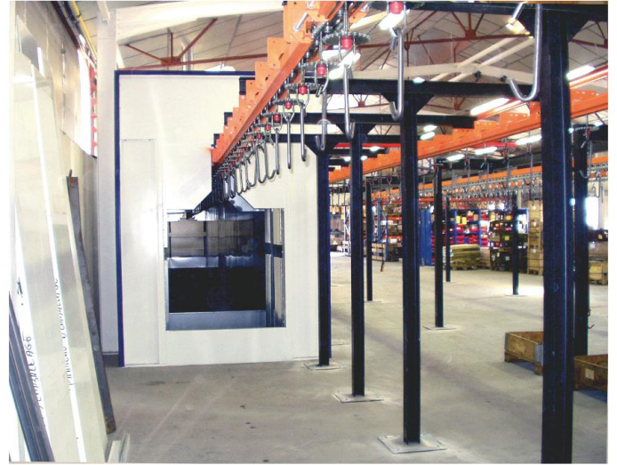
Séchage peinture solvantée ferroviaire* 2
