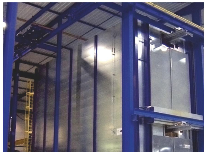
Séchage peinture électrophorèse et cuisson poudre* 2
