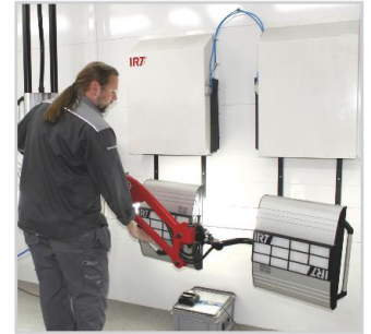
Capotage cassettes IR (rangement et protection)
