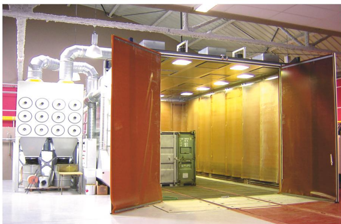
Cabines de grenailage - métallisation
