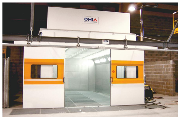
Cabines de lavage-dégraissage
