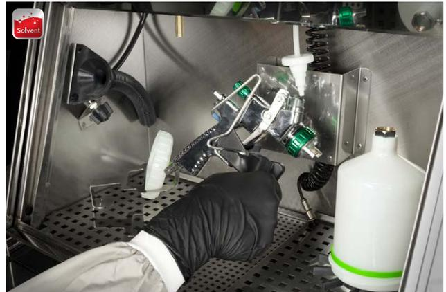
Les configurations de buses et les modèles de projection personnalisés garantissent un nettoyage de qualité supérieure. Composants amovibles et faciles à nettoyer. Vaporiser la buse avec du solvant frais pour le rinçage.
